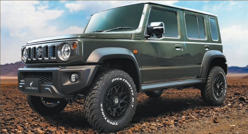
SUZUKI JIMNY NOMADE COLOR : MATTE BLACK P.C.D : 5-139.7 SIZE : F/R 1660 INSET-5 225/75-16 ※上記タイヤの装着は、リフトアップが必要になり、タイヤが突出します。(215/70-16 をおすすめします)
